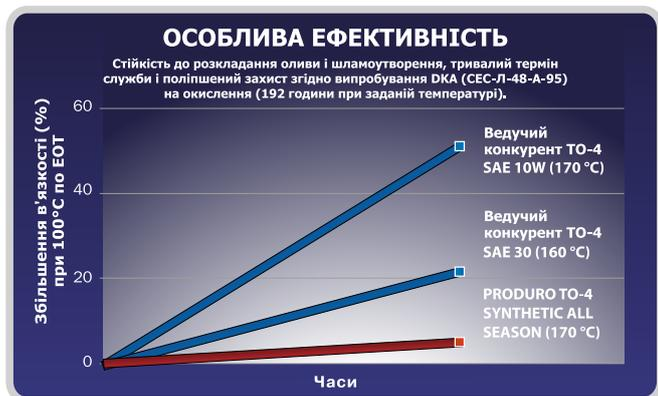
У випробуванні DKA на окислення, ефективність продукту вимірювалася шляхом вимірювання шкідливого підвищення в'язкості в одиницю часу (чим лінія більш горизонтальна, тим краще). У порівнянні з провідним конкурентом вдосконалений склад оливи Petro-Canada **PRODURO TO-4 + Synthetic All Season** краще перешкоджає розкладанню оливи.<sup>1</sup>
